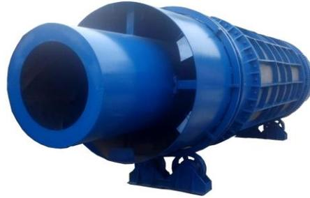
多功能双回程烘干机是我公司（郑州捷恒机械设备有限公司）自行研发自主知识产权产品。该烘干机采用内外双层筒体，外层 310S 不锈钢筒体直接用火加热，内层余热加热，内层预烘干，外层深层烘干的双回程烘干结构！
